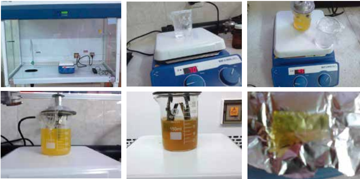
Figura 3.6. Proceso de síntesis y deposición de la capa de CdS sobre el sustrato vidrio-SnO 2 a (70 ± 0.2) °C a) campana extractora de gases b) calibración de temperatura de plato del hot plate con la temperatura de solución c) deposición a 0.4M de tiourea d) deposición a 0.5 M de tiourea e) deposición a 0.6 M de tiourea f) Película terminada de SnO 2 -CdS sobre vidrio.
