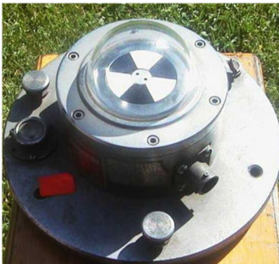
Figura 6. Piranómetro negro y blanco de Eppley. Unas placas pintadas de blanco y de negro actúan como sensores.
