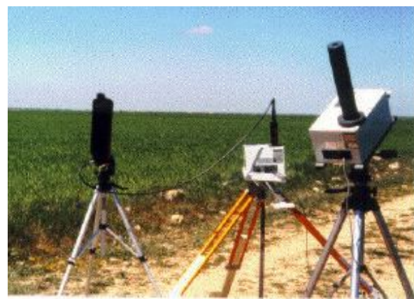
Figura 15. Espectrorradiómetro Licor-1800. Rango de operación 300-1100. Apertura 4.7°. Universidad de Valencia, Grupo de Radiación Solar.
