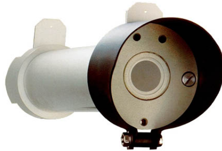
Figura 5. CH-1 NIP (Normal Incidence Pyrheliometer) está diseñado para realizar medidas automáticas de la radiación solar directa, de 0.2 a 4.0 \mu\text{m} . Está diseñado para su utilización con cualquier modelo de seguidor solar Kipp & Zonen. Tiene la opción de acoplar una rueda de filtros manual para modificar la entrada estándar de 200 nm, a 530, 630, o 695 nm. Kipp & Zonen.
