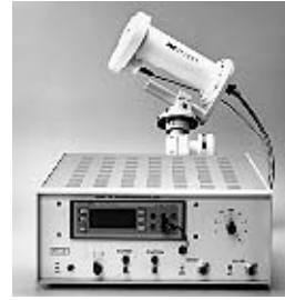
Figura 2. Pirheliómetro autocalibrable de cavidad absoluta Modelo HF. Este modelo ha sido un estándar de referencia durante muchos años. CMDL (Climatic Monitoring and diagnostic Laboratory) Solar & thermal Atmosphere Radiation. NOAA. USA.
