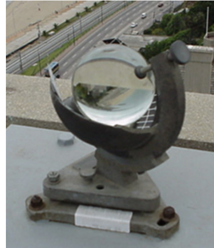
Figura 13. Heliógrafo Campbell - Stokes.
