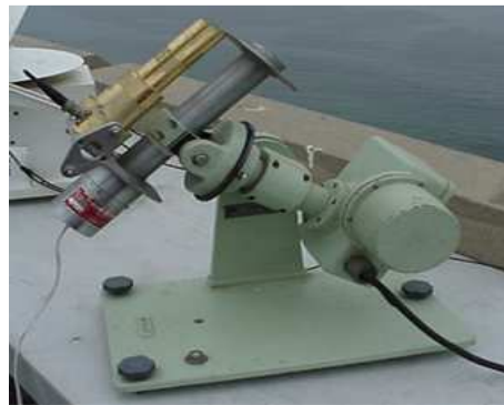
Figura 7. Pirheliómetro Eppley de incidencia normal (montado sobre un seguidor de sol). (Fuente: IDEAM).
