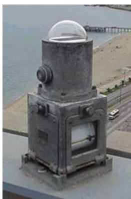
Figura 9. Actinógrafo Fuess. (Fuente: IDEAM).
